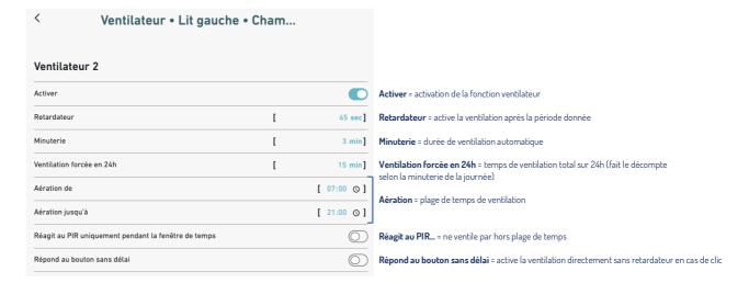
Exemple d'utilisation : après 45sec, la ventilation démarre pour 3min. Si la ventilation fonctionne 2x 3min (totale 6min), la ventilation forcée fonctionnera 9min pour atteindre 15min sur 24h. Comme l'aération est défini jusqu'à 21:00, les 9min restantes démarreront à 20:51.
